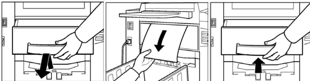
Lấy hộp Master thải ra khỏi máy (H1) . Lấy Master đang bị kẹt trong máy (H2) .
